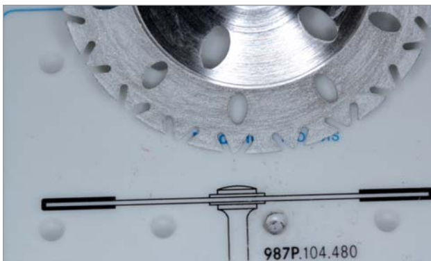
Abb. 8: Gut verzahnt – eine große Diamantscheibe 987P von Komet trennt Klasse-IV-Gipse und Modellkunststoffe superleicht.
