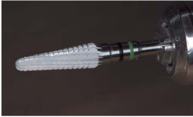
Abb. 5: Gewöhnliche Fräser überhitzen und verschmieren elastische Werkstoffe. Besser ist die spezielle GSQ-Verzahnung mit Querhieb von Komet – hier als CeraLine mit einem Keramik-Arbeitsteil.
