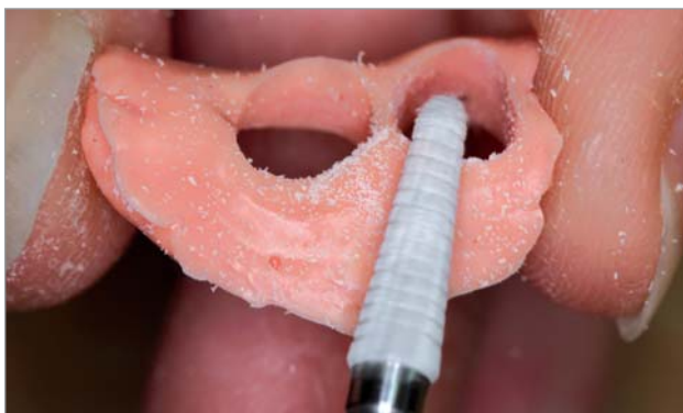
Abb. 6: Die GSQ-Verzahnung setzt sich beim Bearbeiten des Softkunststoffes nicht zu.
